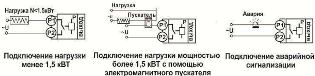
Рисунок 3.Схемы подключения релейного выхода
